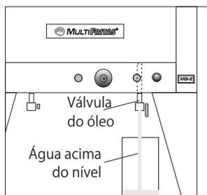
Quando fritar alimentos que produzam resíduos em excesso (farinha dos empanados em geral), deve-se proceder com regularidade a sangria do óleo - retirada do excesso de água. Para este procedimento, abra um pouco a válvula do óleo e deixe escorrer o excesso de água da cuba. Quando o óleo começar a sair feche a válvula e volte a operar normalmente.
