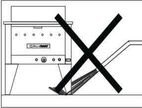
Ao limpar o local onde estiver instalado o equipamento, evite jatos d'água para não molhar as partes elétricas de seu interior, procurando protegê-las da umidade.
