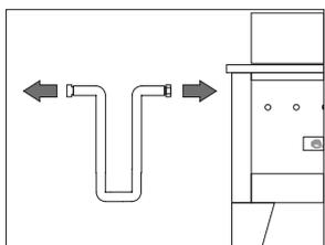
Conecte a mangueira de ligação na parte traseira do equipamento e a outra ponta na conexão de saída da rede de gás.
