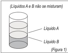
Este sistema é baseado na diferença de densidade de dois líquidos que não se misturam. O qual é fundamental para evitar a contaminação dos sabores e também aumentar a vida útil do óleo (fig. 1).
