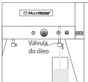
Coloque um recipiente limpo sob a saída da válvula do óleo e abra a mesma, esgotando todo o óleo da cuba, armazenando-o para reaproveitamento ou eliminação.
