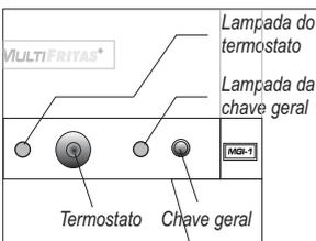
Acione a chave geral, gire o dial do termostato até a indicação da temperatura escolhida; quando a lâmpada apagar significa que o óleo atingiu a temperatura escolhida..
