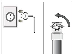
Ligue o plug do cabo elétrico da máquina na tomada da rede elétrica, se certificando antes se a voltagem coincide com a da máquina, e, na parte traseira, libere o gás para o equipamento.
